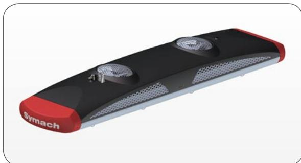
Il Solarys Ware House è un sistema di riscaldamento a radiazione per capannoni industriali ed è composto da una o più lampade catalitiche con tecnologia Drytronic, alimentate a gas (Metano o GPL), che vengono installate a 4-5 metri da terra; potendo parzializzare l'accensione di una o più lampade è possibile riscaldare capannoni interi o solo zone specifiche.
